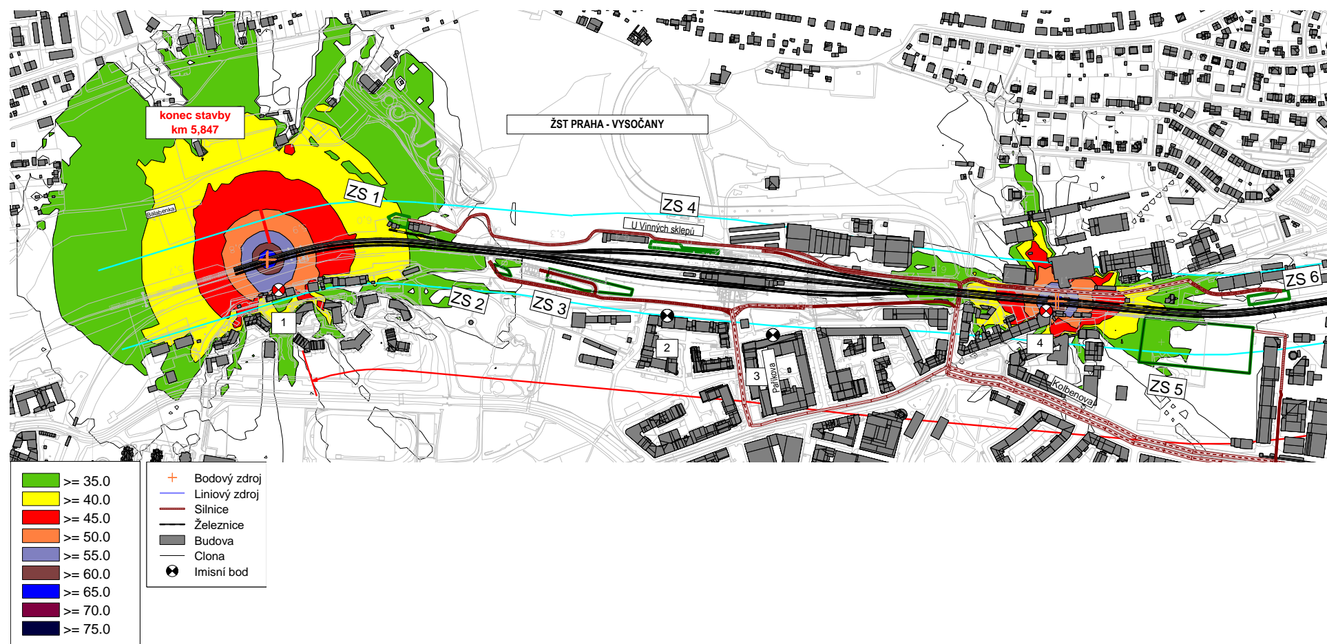
Obr. 35 Hluková mapa – montáž břeven trakčních bran: Vysočany (noční doba 22:00 – 6:00 – práce v době 0.00-04.00)
